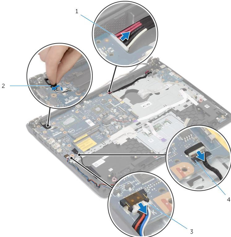
1 Kabel vrat za napajalnik
