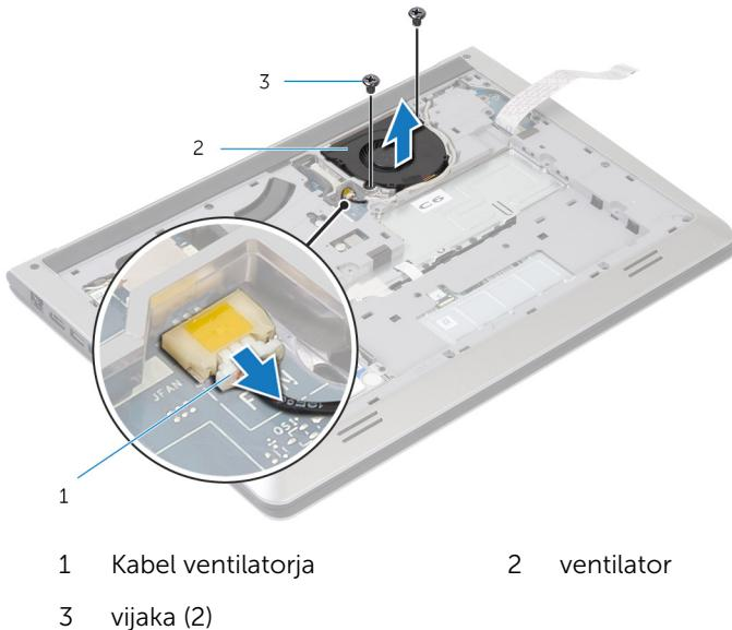
**8** Dvignite ventilator iz ohišja računalnika.
